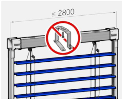
Selbsttragend ohne zusätzliche Befestigung, schont die Isolation und ist einfach zu montieren.
